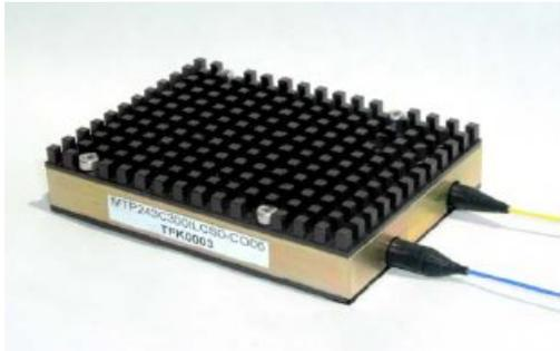
Multiplex 社製 MTP243 トランスポンダーはコンパクトな平坦なパッケージに APD またはピン PD とともに MTX-EML (電界吸収型変調器レーザー) 光伝送器、ヒートシンク等が集積されております。当製品は DWDM 応用の際は波長ロックバージョンの適用が可能です。MTX-EML は MTX-510EW(1550nm), 並びに MTX-310EW(1310nm)に対応いたします。MTP-243 のピン構成は **300ピン MSA, SFF** 対応です。
