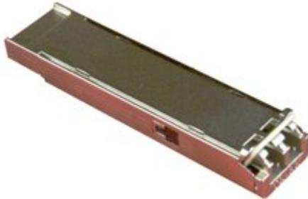
Multiplex 社製 MXP は高性能な 9.95Gb/s から 11.1Gb/s のデータレートや 80km までの 10G SDH/ SONET, 10GEthernet その他光ファイバー伝送用途に優れた性能を発揮するコストパフォーマンスの優れた製品です。モジュールは伝送部分と受信部分の2つの部分から構成されます。構成は EML(1310nm 又は 1550nm, ITU チャンネル又は可変波長), レーザドライバ, 伝送部分と APD/PIN ROSA 部分を含んだ回路並びにレシーバ部分の回路等から構成されております。マイクロコントローラがモジュールと主要ボードの間の相互コミュニケーションを行いさらに伝送と受信部分の制御とモニタリングを行ないます。CDR はクロックと双方向のデータ再生用ファンクションを発生します。
